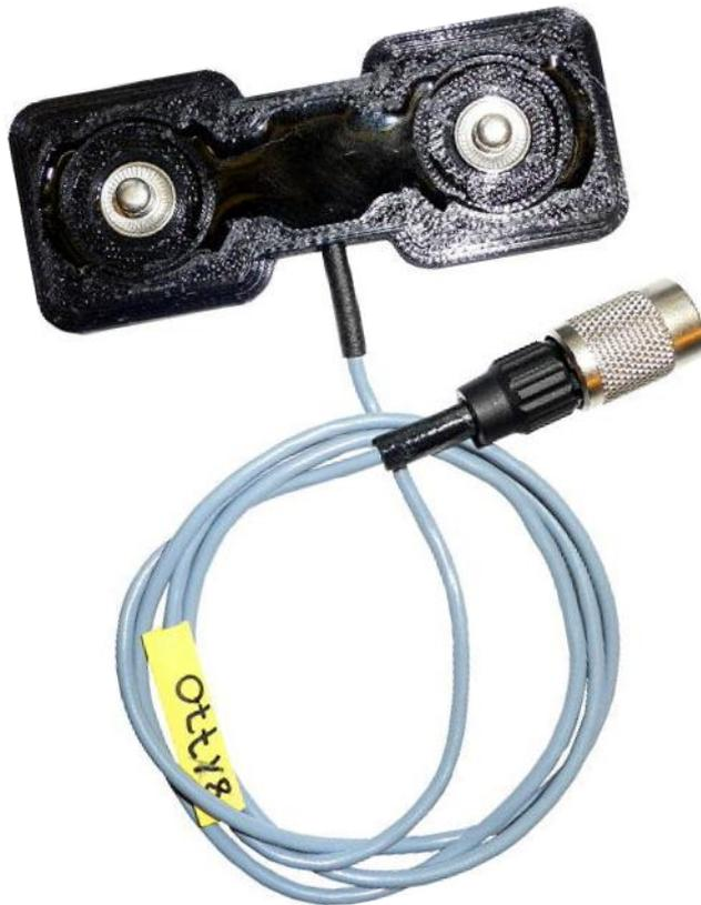
Im Rahmen von Messung mit dem psychophysiologischen Monitoring-System HealthLab wird das HealthLab Sensorkabel EGA-01 zur Erfassung eines 1-kanaligen Elektrokardiogramms (*Brust - Ableitung*), z.B. am HealthLab Master HFM-01 oder am NeuroLab NL-2010 Base-Modul eingesetzt. Der EKG-Gurtadapter wird in Verbindung mit einem Brustgurt eingesetzt. Hierbei wird das EKG-Signal kabelgebunden an das Messmodul geleitet.
