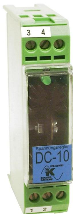
Das Spannungsreglermodul enthält einen Längsregler Typ L78XX, der mit einer Diode, zwei Elkos und einer grünen Betriebs – Leuchtdiode beschaltet ist. Das Modul ist in verschiedenen Spannungsversionen zwischen 5 V und 24 V lieferbar.
