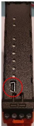
Um das Gerät über die Mini-USB Schnittstelle parametrieren zu können, ist die Installation des Gerätetreibers und der Parametriersoftware auf dem PC-System notwendig.
