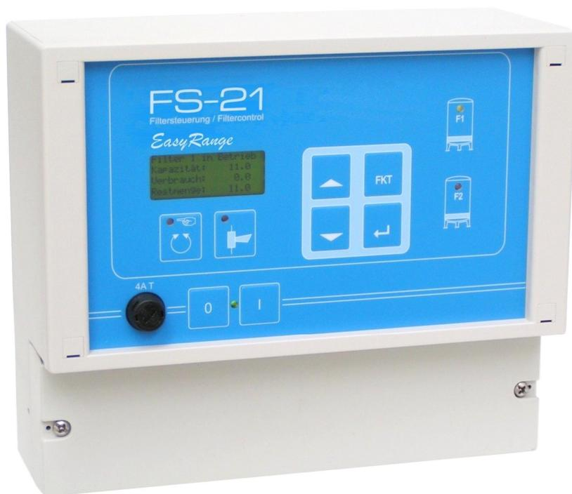
Die Filtersteuerung FS-21 erfüllt die Grundaufgaben für die Steuerung einer Ein- oder Zweifilteranlage mit Pilotverteilmern oder Zentralsteuerventilen. Die Ventiltypen werden über die Konfiguration ausgewählt und die FS-21 passt sich im Funktionsablauf automatisch dem gewählten Ventiltyp an. Es können sowohl EntkarbonisierungsfILTER als auch Kiesfilter gesteuert werden. Für komplexere Anwendungen und mit einem erweitertem Funktionsumfang empfehlen wir den Einsatz unserer Filtersteuerung FS-201.
