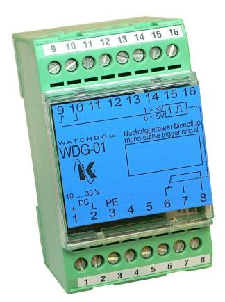
Der Watchdog WDG-01.2 ist ein nachtriggerbares Monoflop zur Überwachung von Zyklen mit Puls / Pause – Zeiten bis zu 10 Sekunden. Er kann z.B. zur Überwachung von SPS – Zyklen oder Rechner – Zyklen eingesetzt werden. Ein weiterer Anwendungsfall kann die Umsetzung von Proportionalimpulsen bei Dosiersteuerungen in Dauersignale, z.B. zur Ventilansteuerung, sein.
