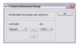
Über die Drop-Down - Auswahl der Schnittstellen (siehe Abb. links) ist ein bereits registrierter COM-Port, mit dem das Gerät verbunden ist, oder –
